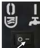
Schalter in Festwasserposition „1“
