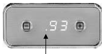
Temperatuur koffie boiler (t1, hier 93°C) -Komma in de 1e positie.
